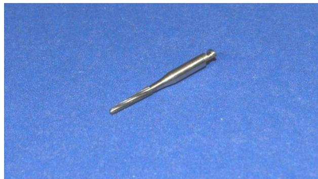
Slika 1. Fisurno tungsten-karbidno svrdlo
