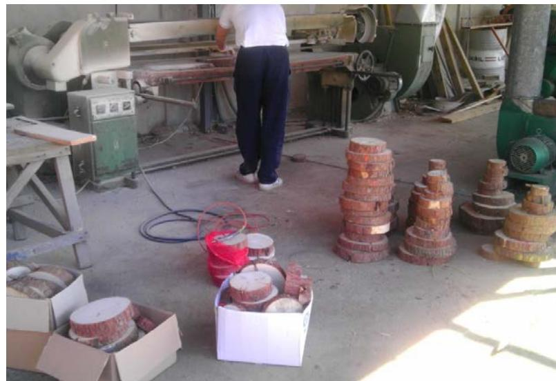
**Slika 9.** Sušenje i brušenje koturova (original, 2013)
