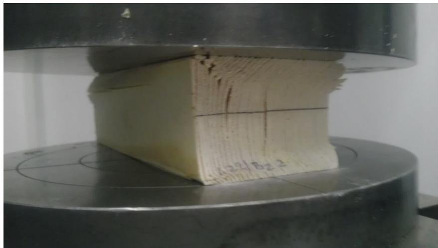
**Slika 20.** Ispitivanje napona na pritisak upravno na vlakanca (original, 2015)
