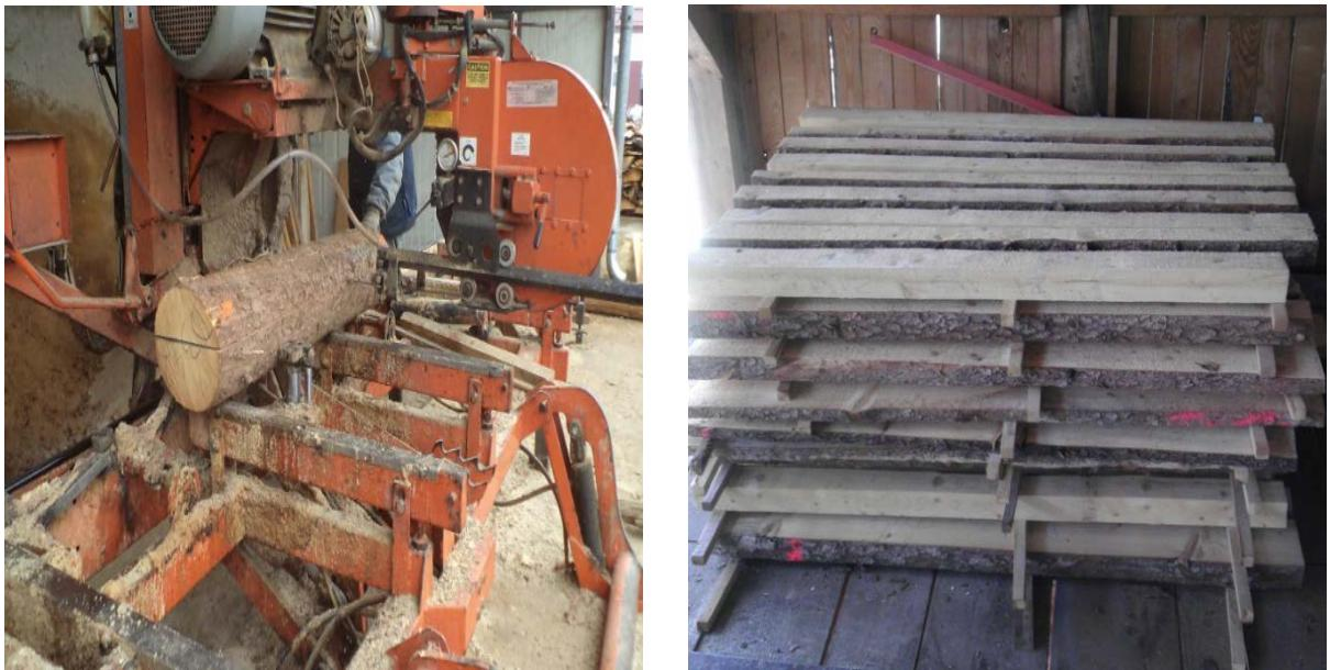
**Slika 14.** Proces izrade dasaka iz trupaca (rezanje i sušenje) (original, 2013)
