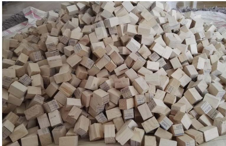
Slika 12. Izrezane epruvete (original, 2014)
