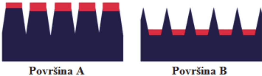
*Slika 1.12. Dva profila sa istom Ra vrijednosti, ali sa značajno različitim površinskim karakteristikama. Crveno označena površina određuje „idealni“ oblik površine. Profili imaju istu vrijednost parametra Ra jer je odstupanje od idealne forme iste veličine [20].*
