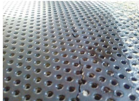
*Slika 5.9. Oštećenje gumene obloge slijepobušene prese*
