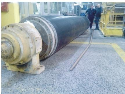
*Slika 5.8. Oštećenje cijevi od hlađenja slijepobušene prese*
