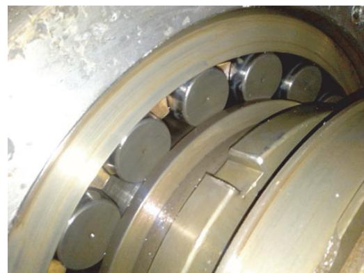
Slika 5.3. Postojanje zazora od 5 mm između matice za stezanje i ležaja
