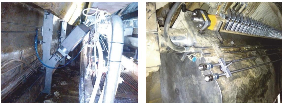
Slika 5.11. Provodenje korektivne mjere 2– dodatni pneumatski cilindri i nosači/prsti
