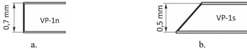
Sl.1.3. Konfiguracije *hot-wire* sondi sa jednim senzorom, a. sonda sa normalnim senzorom, b. sonda sa nagetim senzorom [15]
