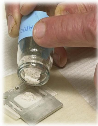
Slika 22. Priprema uzorka za XRD analizu [80]
