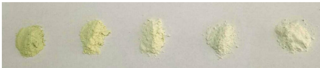
Slika 27. ZnO nanoprah dobijen solvent free metodom
