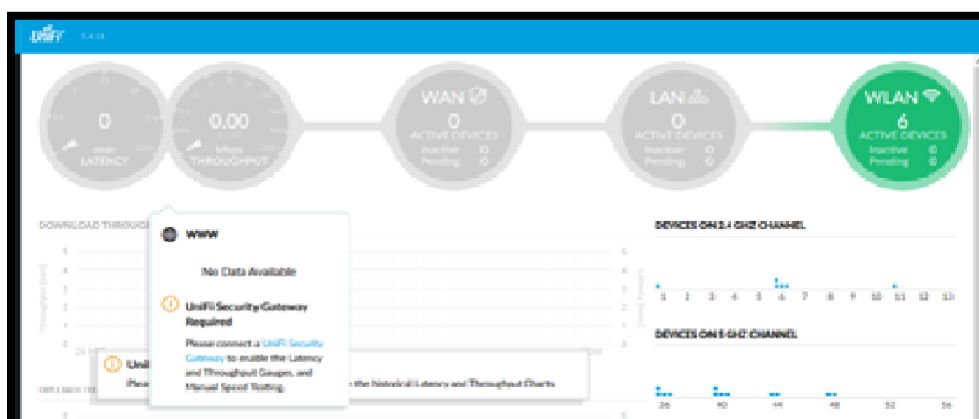
Слика 4.2 - Активни WAPs и клијенти на каналима у опсезима 2,4GHz и 5GHz
