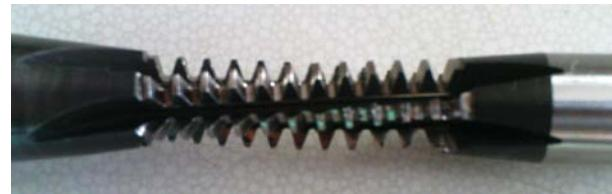
Sl.7.4. Slike glodala za izradu pužnog zupčanika
