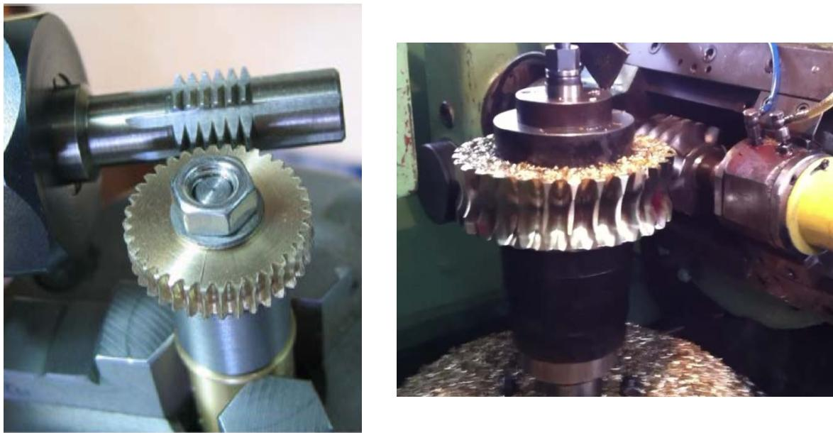
Sl.5.8. Izrada pužnih zupčanika postupkom relativnog kotrljanja
