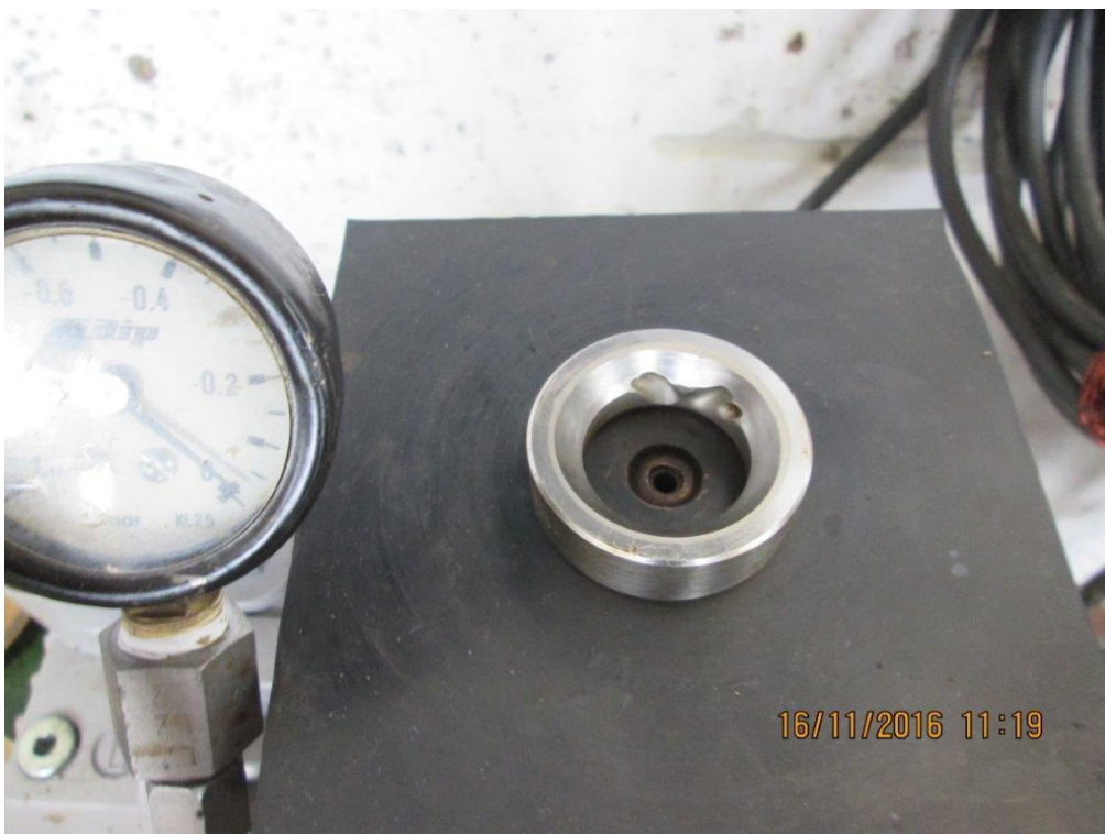
Слика 4.2 Оштећење сједишта куглице
