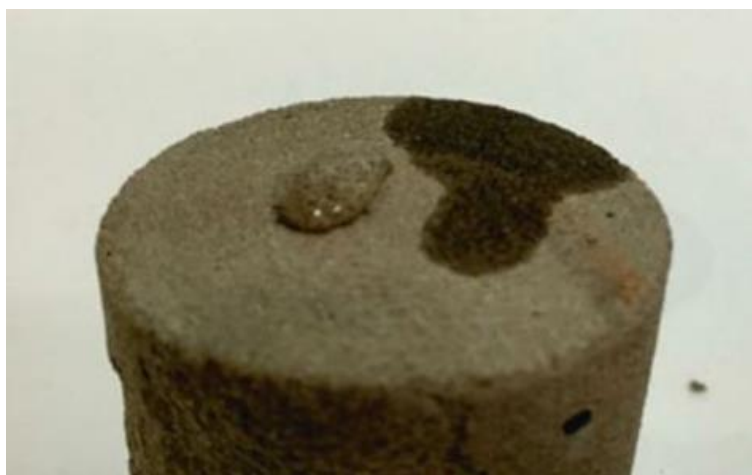
Слика 3.14. - Фотографија пешчара обрађеног хемикалијом после извођења квалитативног експеримента у циљу провере хидрофобних својстава: лево – капљица воде, десно – трагови упијене капљице петролеја
