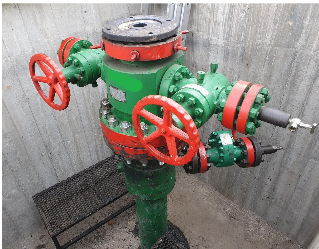
Slika 14. – Montiran Tubing adapter „kezing adapter“ na bušotini
