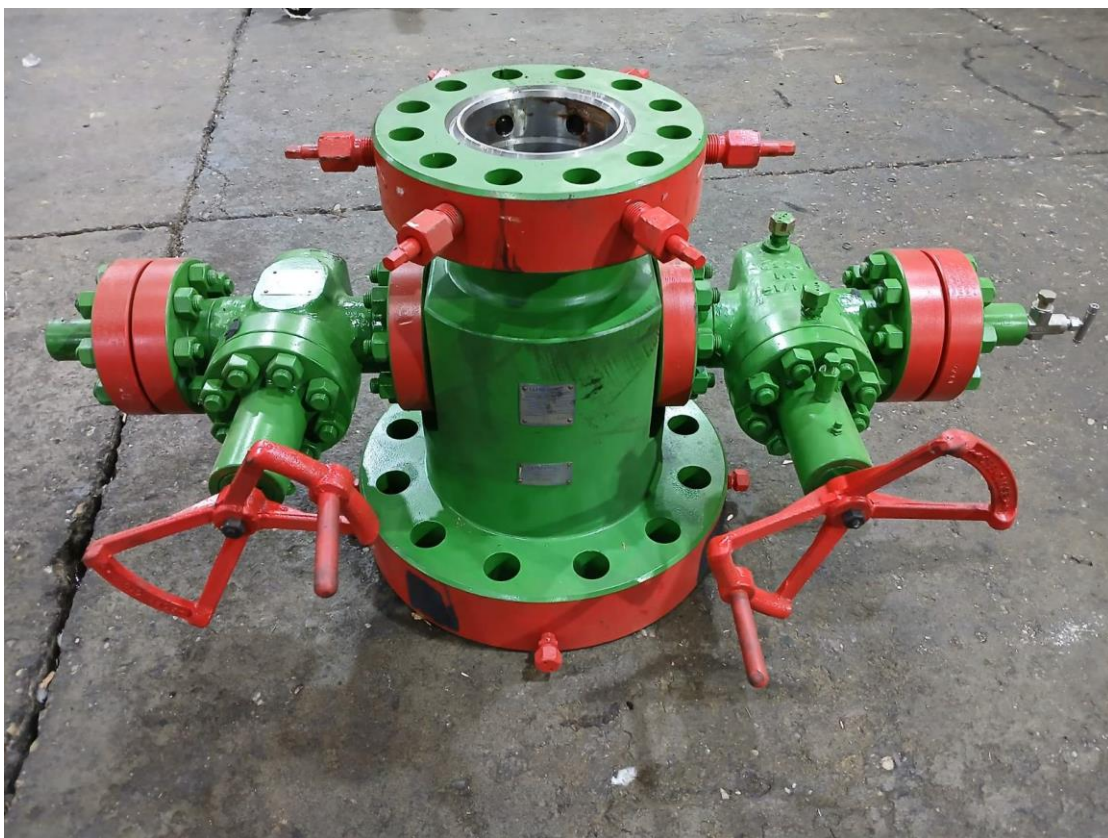
Slika 13. – Tubing adapter „kezing adapter“
