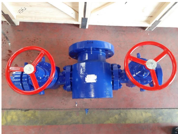
Slika 5. - Direktni erupcioni uređaj (Uvodna prirubnica)
