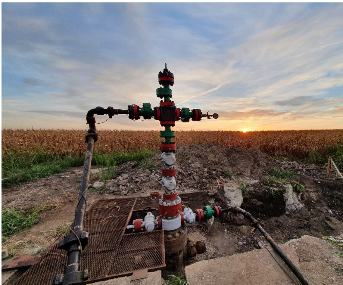
Slika 33. – Gušenje bušotine – priprema za remontne radove za konzervaciju bušotine
