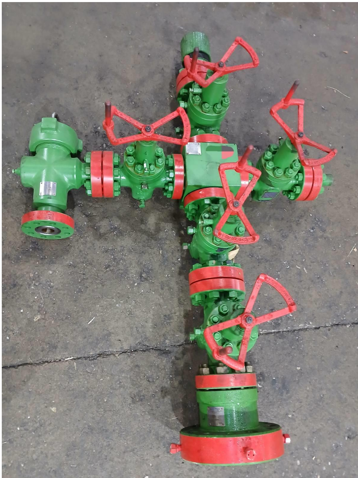
Slika 16. – Gornji deo erupcionog uređaja „erupciona jelka“
