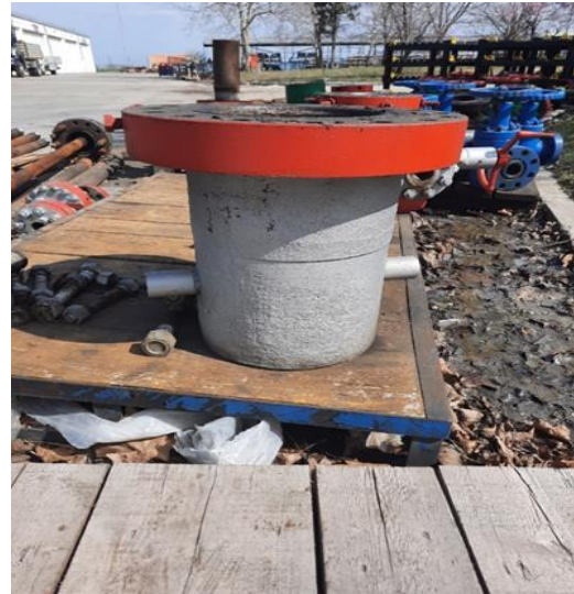
Slika 5. Uvodna prirubnica (Casing head) (Izvor: Dr. Renato Bizjak „Tehnologija bušenja sa projektovanjem“; privatno)
