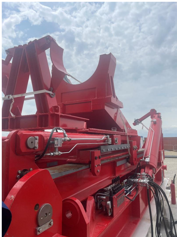
Slika 28. BOP kolica „BOP cart“ na postrojenju pre montaže opreme (Izvor:privatno)
