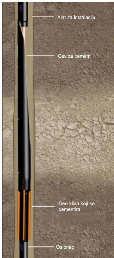
Slika 3.9 - Konstrukcija stalnog klina (www.tmot.ca)
