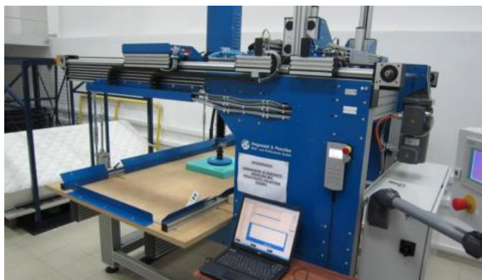
Slika 3.4. Uređaj za ispitivanje mehaničkih svojstava spužve
