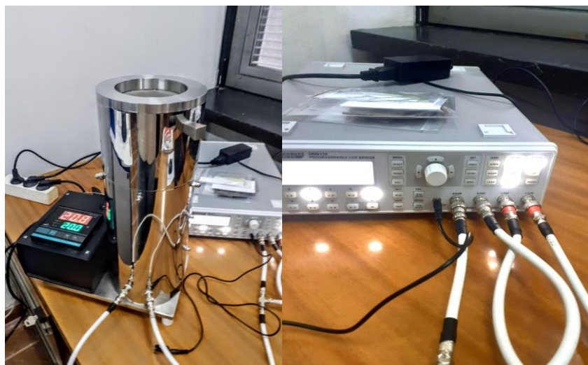
Slika 3.15. Uređaj LCR Hamag 8118 korišten za ispitivanje dielektričnih svojstava
