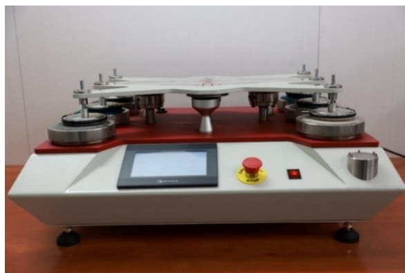
Slika 3.7. Martindale tester abrazije i pilinga
