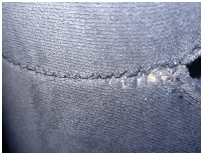
Slika 2.13. Oštećenje tkanine na mestu šava sedalnog dela
