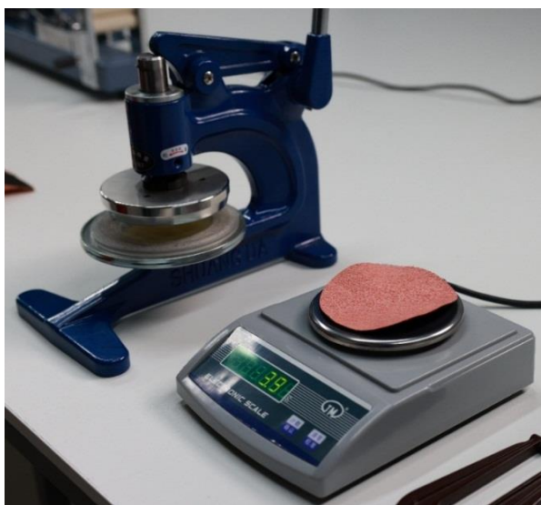
Slika 3.6. Rezač za sečenje epruveta kružnog oblika i elektronska vaga
