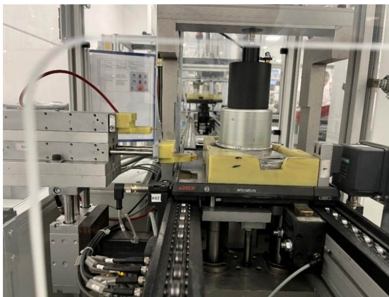
Слика 5.8: Начин остваривања контакта мјерног система са електромотором.
