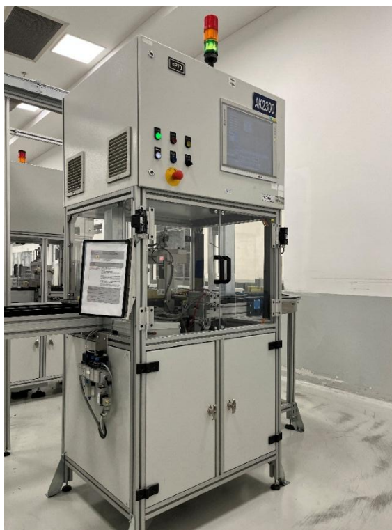
Слика 5.7: Изглед јединице за мјерење електричних карактеристика AK2200.
