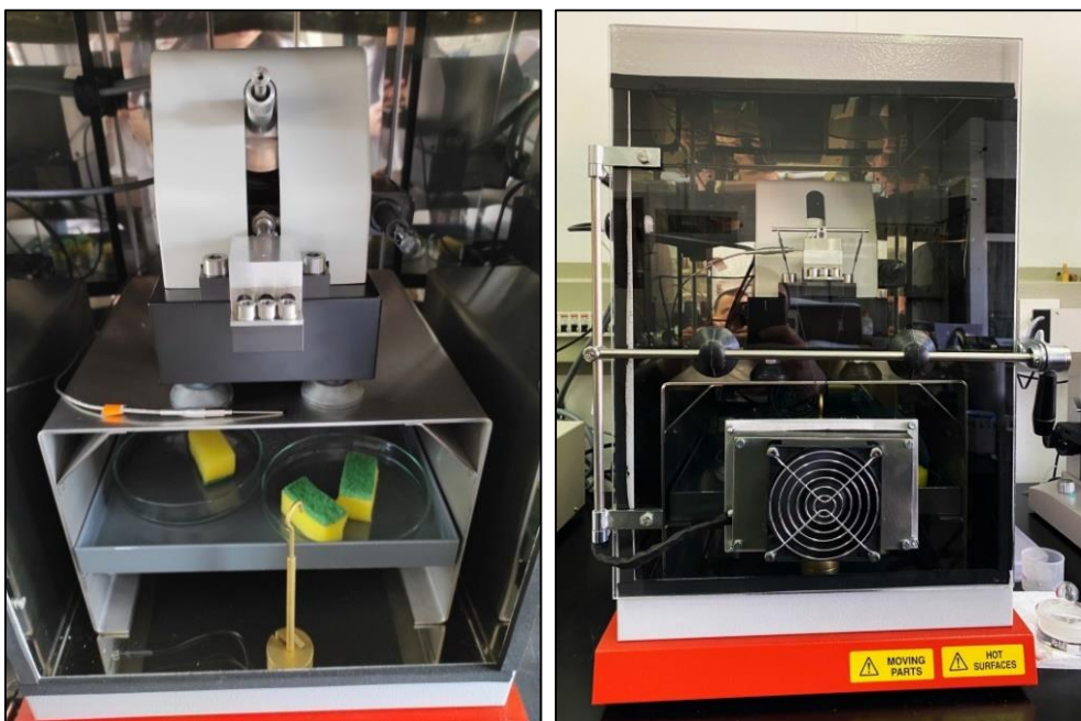
Слика 8. HFRR комора са механичком јединицом
