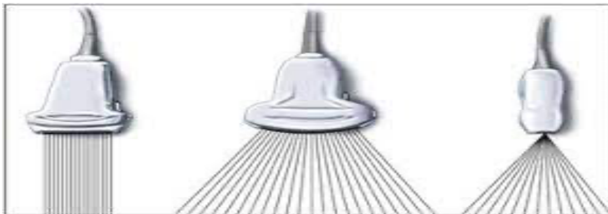
Slika 25. Šematski prikazan snop ultrazvučnih talasa različitih oblika ultrazvučnih sondi. Sa lijeva na desno se uočavaju linerna sonda, konveksna sonda, te kardiološka sonda (88).
