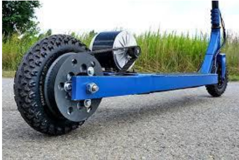
Slika 17. Mid-drive motor sa zupčastim remenom na električnom trotinetu [15].
