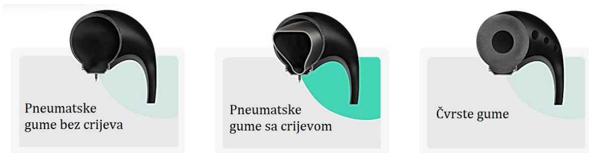
Slika 14. Tipovi guma koji se najčešće mogu pronaći na električnim trotinetima: a) pneumatske gume bez crijeva, b) pneumatske gume sa crijevom, c) čvrste gume [9].
