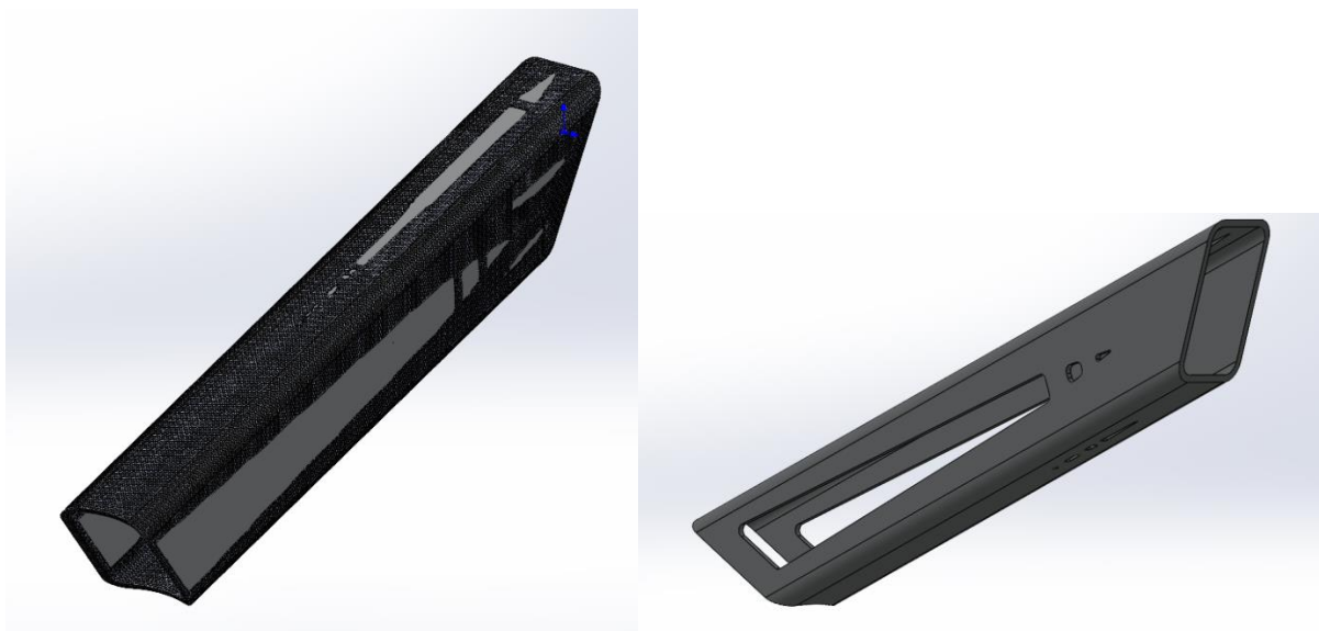
Slika 51. Uporedni prikaz mreže optimiziranog početnog modela i modela pravougaone cijevi nakon isjecanja.
