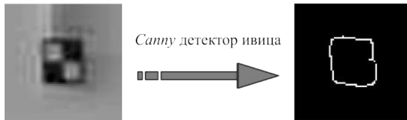
Слика 4.6: Примјена Canny алгоритма: а) Сегмент слике издвојен SIFT алгоритмом, б) Резултат примјене Canny алгоритма
