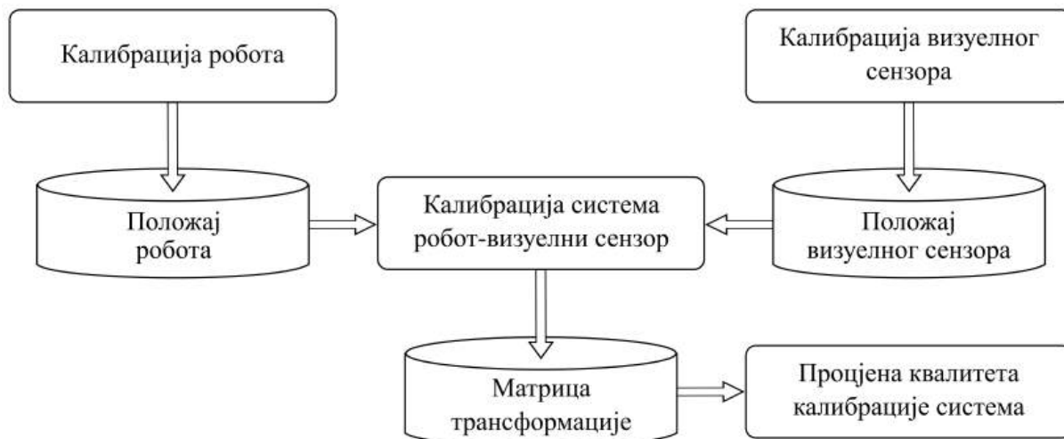
Слика 3.3: Дијаграм тока калибрације система робот-визуелни сензор
