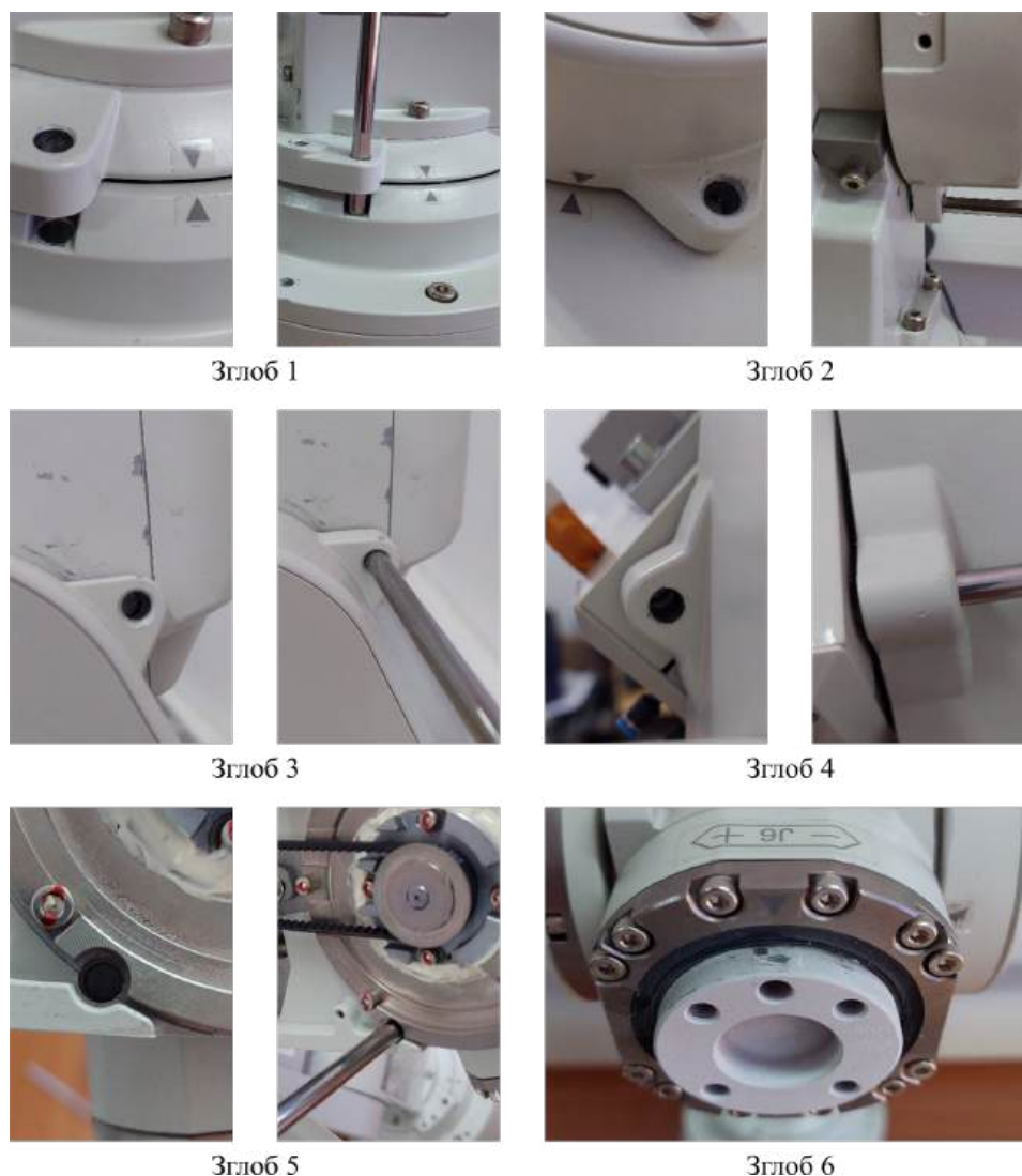
Слика 8.2: Калибрација нулте позиције робота
