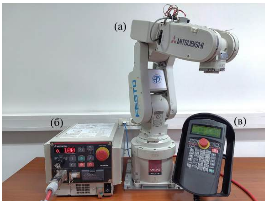
Слика 7.2: Фотографија робота Mitsubishi RV-2SDB: а) Манипулатор, б) Контролер, в) Ручни управљачки уређај
