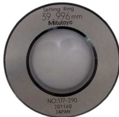
Слика 7.11: Калибрациони прстен Mitutoyo NO. 177-290 (2011160)
