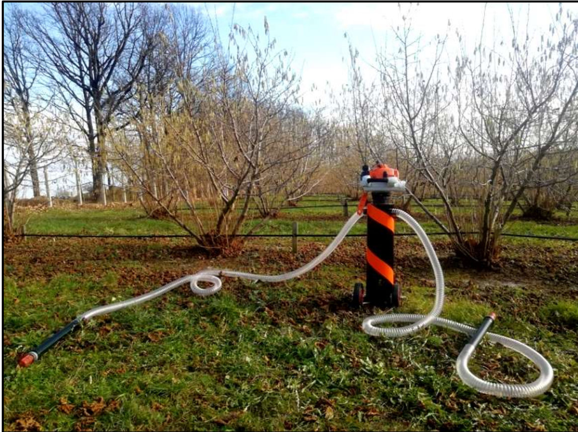
Слика 13. Аспиратор "Aspir rolline" за механизовано прикупљање полена на локацији Шушњари (Лакташи) 2019. године.
