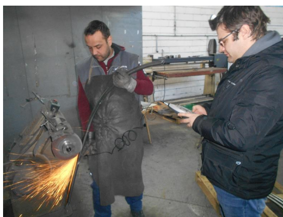
Slika 19. Postupak mjerenja vibracija pri radu na dvostranoj stubnoj mašini za poliranje Vrijeme trajanja mjerenja je reprezentativno vremenu koje je potrebno da se obradi metalni pripremak po cijeloj površini i iznosi pet minuta.
