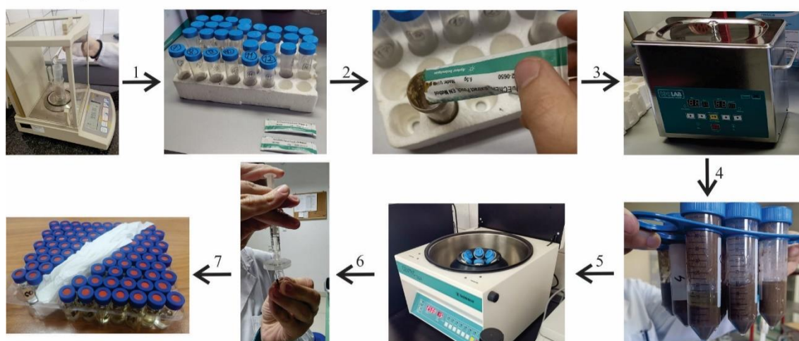
Slika 7. Priprema uzoraka za izdvajanje nikosulfurona iz zemljišta radi utvrđivanja degradacije
