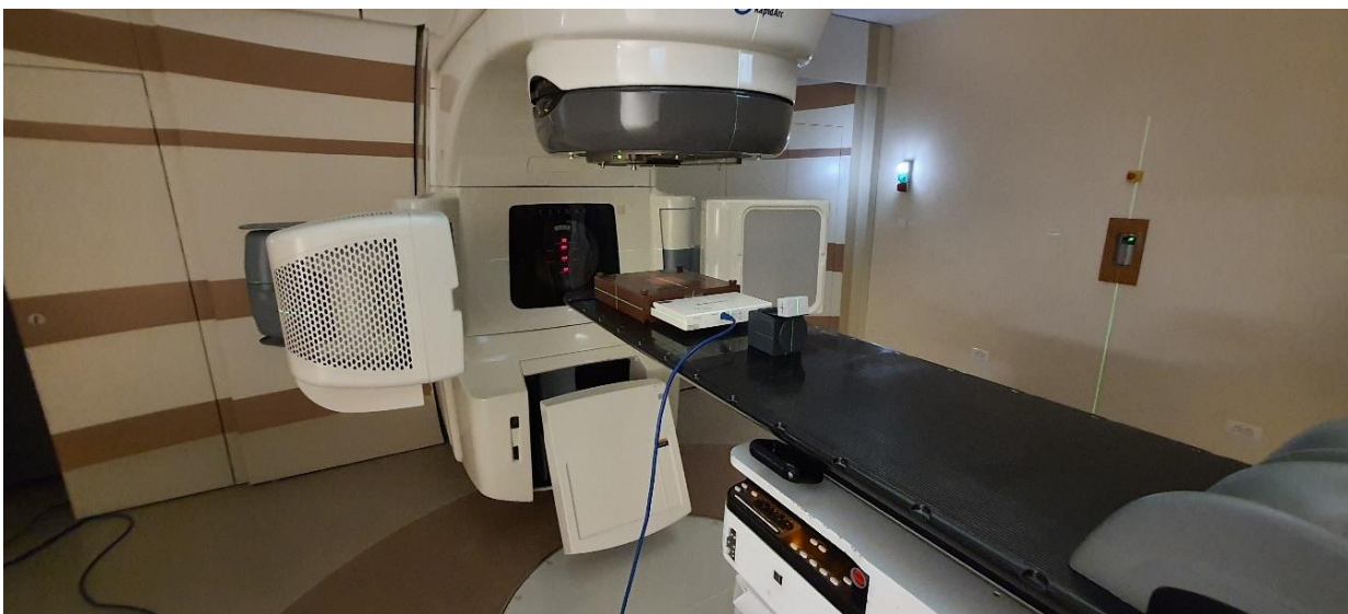
Slika 15. Postavka MapČek detektora sa MapFan fantomom na linearnom akceleratoru
