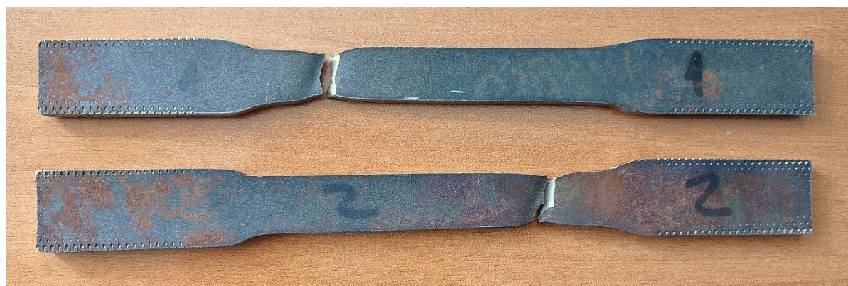
Slika 55. Epruvete nakon ispitivanja na kidalici.
