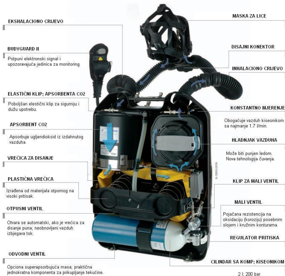
Slika 6. Regeneracioni izolacioni aparat sa komprimiranim kiseonikom DRÄGER PSS BG4 plus, [33].
