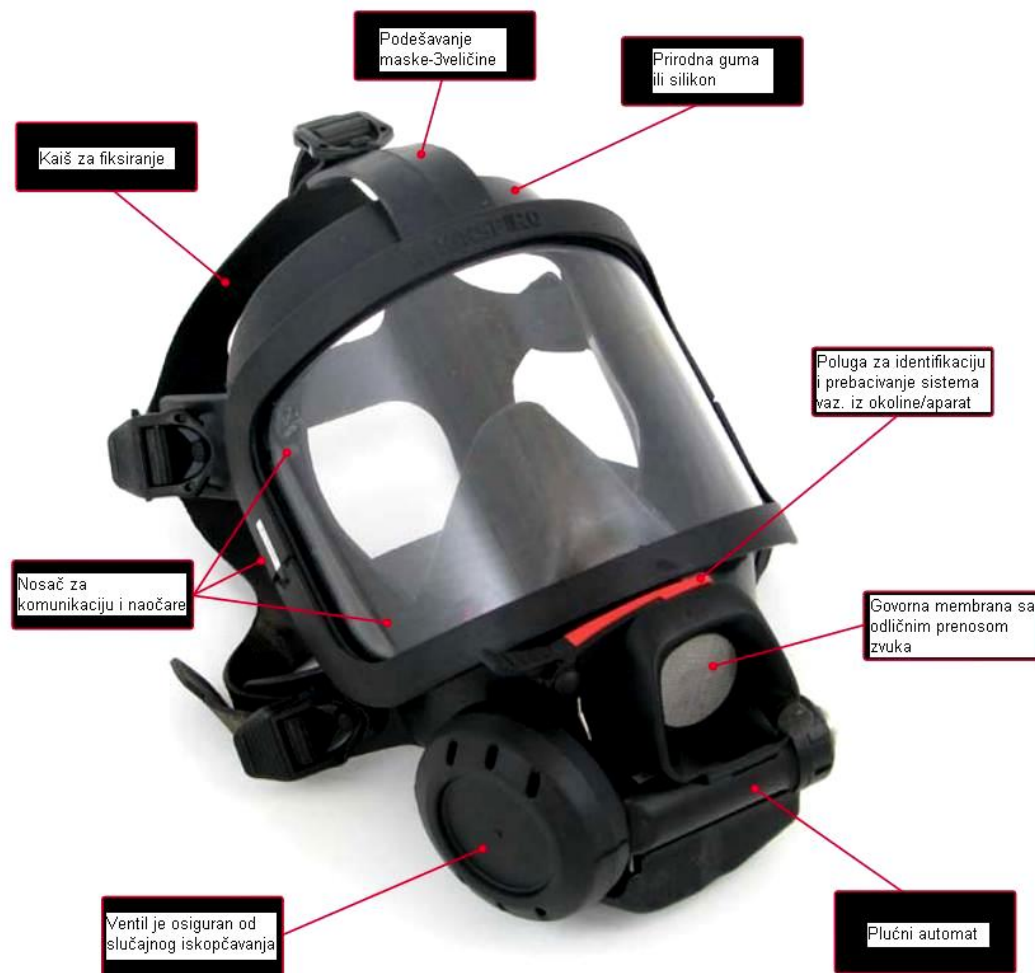
Slika 14. Maska za izolacioni aparat Interspiro QS, [45].
