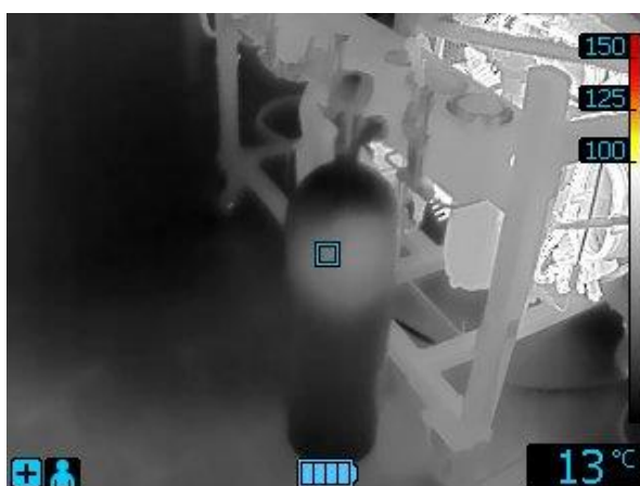
Slika 76. Termovizijska slika – punjenje čelične SCBA boce na kompresoru.
