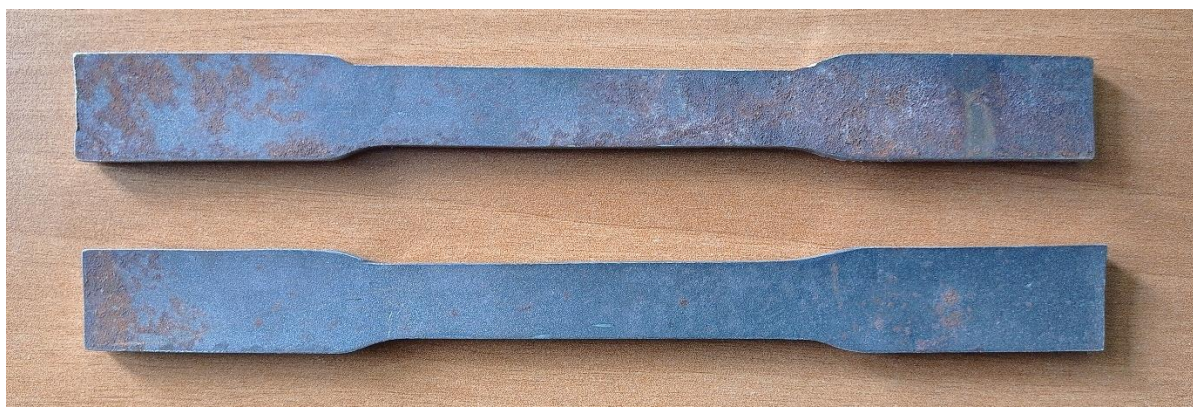
Slika 54. Epruvete neposredno prije ispitivanja.
