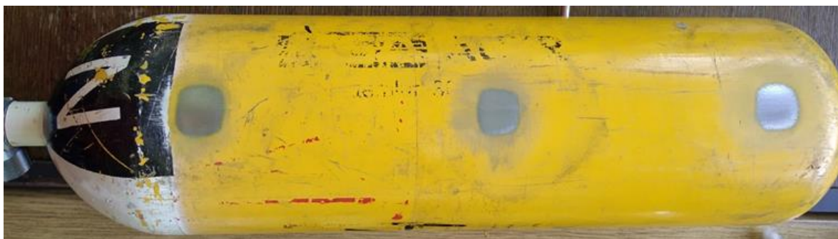
Slika 80. Mjerna mjesta na čeličnoj boci prije lijepljenja mjernih traka.
