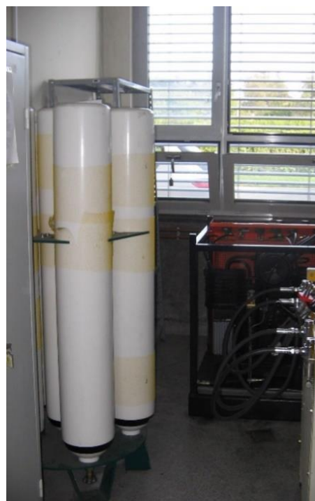
Slika 43. „Banka vazduha“ sa dvije baterije po dvije boce, fiksirana za pod, [7].
