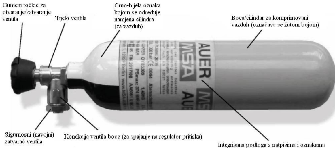
Slika 27. Polukompozitna boca proizvođača MSA Auer, [36].
