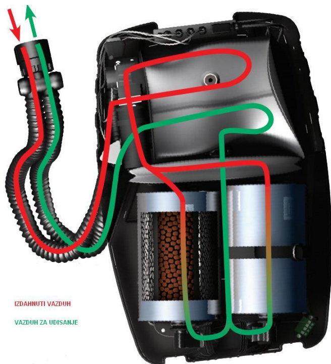
Slika 9. Tok vazduha kroz izolacioni aparat MSA Air Elite 4h, [37].
