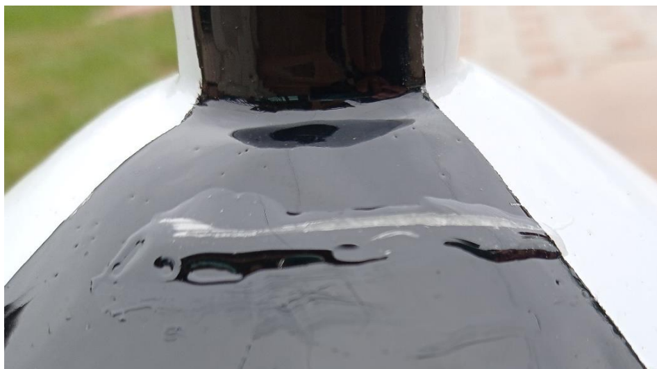
Slika 87. Sanirano oštećenje na polukompozitnoj boci – rez.
