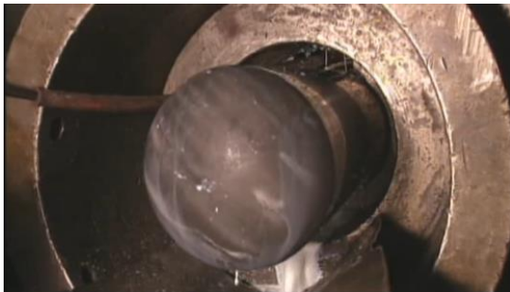
Slika 20. Izrada čelične boce hladnim izvlačenjem, [42].
