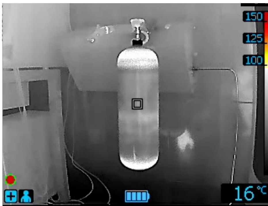
Slika 75. Termovizijska slika – temperatura polukompozitne boce proizvođača Luxfer u toku punjenja na konzoli „banke vazduha“.
