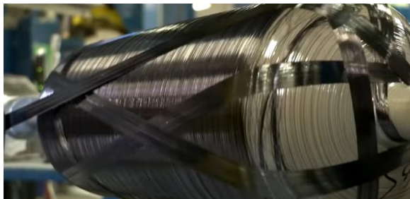
Slika 26. Namotavanje karbonskih i staklenih vlakana na aluminijumsku osnovu, [43].
