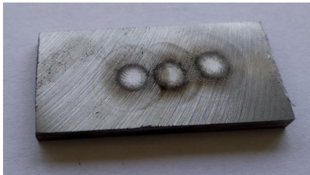
Slika 79. Isječak čelične boce nakon laboratorijskog ispitivanja.
