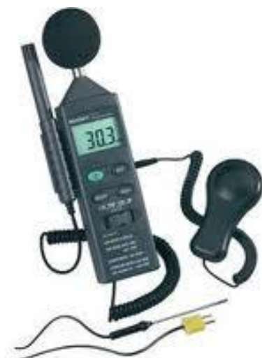
Slika 56. Voltcraft sa internim i eksternim senzorima, [98].
