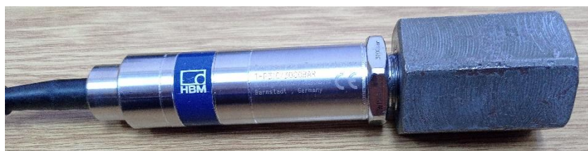
Slika 61. Davač i transponder pritiska HBM 1-P31C/3000 bar s adapterom.
