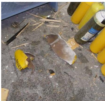
Slika 40. Eksplozija čelične boce IA prilikom punjenja na kompresoru, [35].
