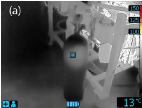
Slika 71. Termovizijska slika – čelična boca na početku punjenja za SCBA aparate 6 l; 300 bar, [7].
