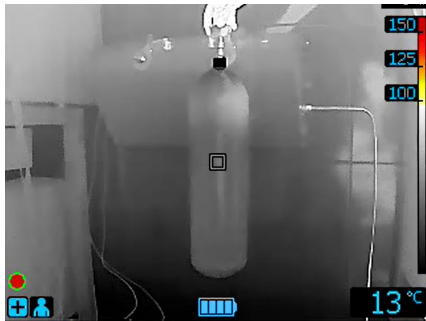
Slika 74. Termovizijska slika – temperatura čelične boce proizvođača Luxfer u toku punjenja na konzoli „banke vazduha“.
