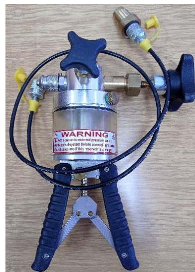
Slika 62. Hidraulična manuelna testna pumpa visokog pritiska CPP 700-H.
