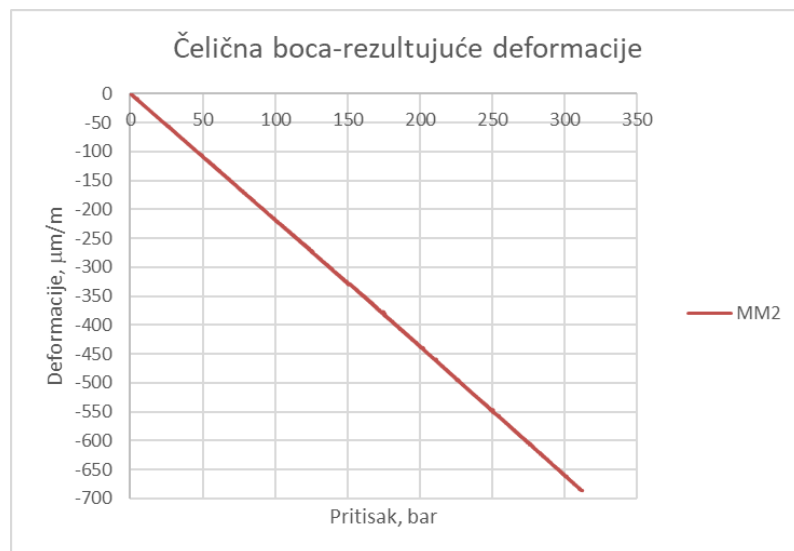
Dijagram 49. Čelična boca – rezultujuće deformacije, ispitivanje vodom od 0 bar do 300 bar za MM2. Intenzitet deformacija na: 50 bar= -109,197; 100 bar= -218,391; 150 bar= -327,902; 200 bar= -437,517; 250 bar= -548,547.
