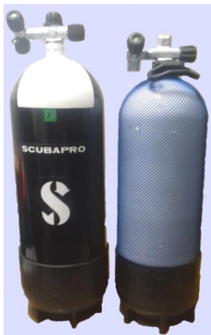
Slika 28. Čelične boce zapremine 18 i 15 l.
