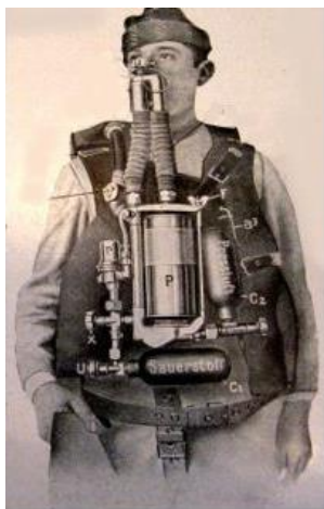
Slika 3. Prvi regeneracioni izolacioni aparat na komprimovani kiseonik, [84].
