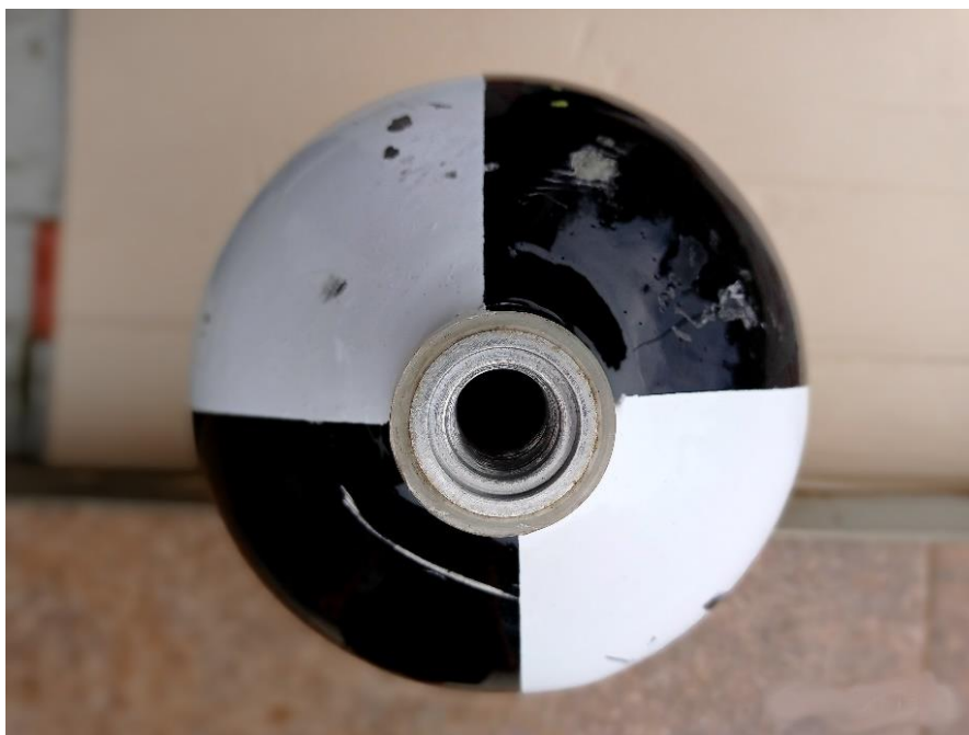
Slika 86. Oštećenja na polukompozitnoj boci.
