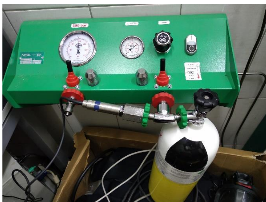
Slika 85. Polukompozitna boca na konzoli „banke vazduha“.
