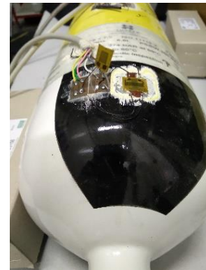
Slika 82. Polukompozitna boca sa zalijepljenim mjernim trakama.
