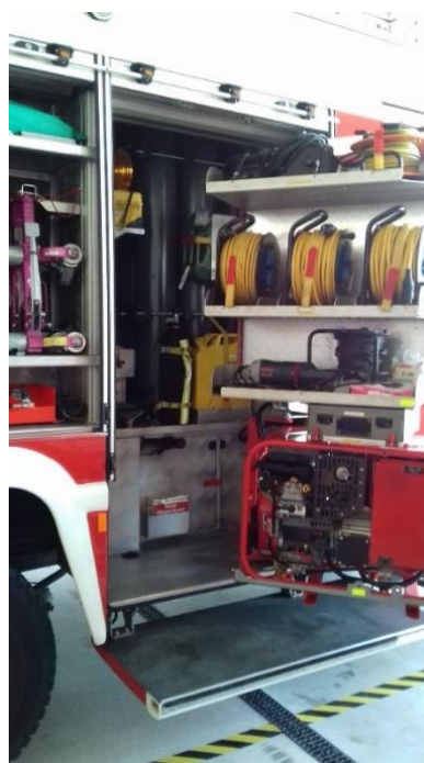
Slika 45. „Banka vazduha“ u vatrogasnom vozilu za gašenje požara u tunelima.
