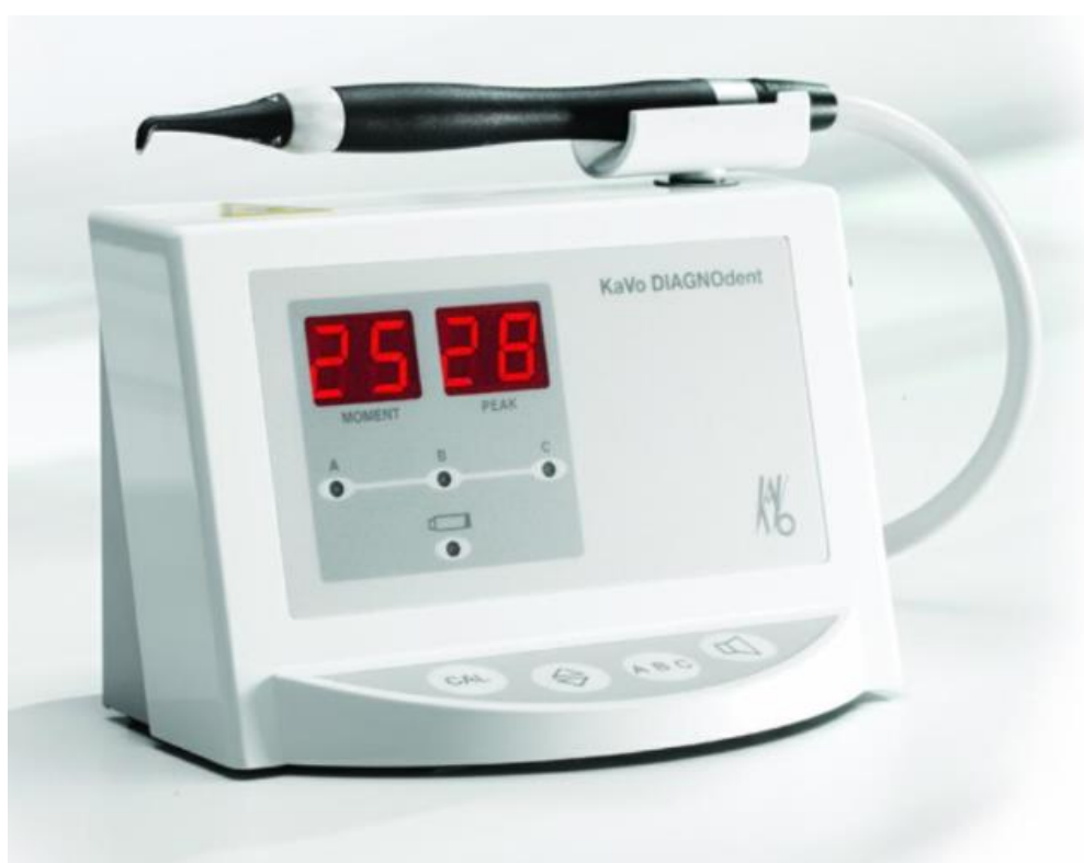
Slika 6. Aparat za detektovanje laserske fluorescencije iz demineralizovane kristalne rešetke zubnih tkiva DiagnoDent® (KaVo, Biberach, Njemačka)
