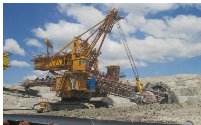
Slika 5.2. Rotorni bager ER – 1250\*16/1.5 [IRM-Bor d.o.o. Zvornik, 2021.]
