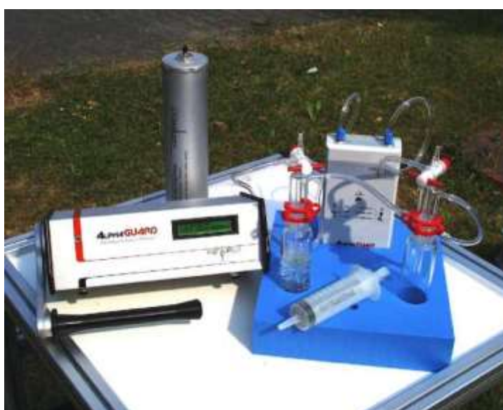
Slika 13. AlphaGUARD 2000 PRO za mjerenje koncentracije aktivnosti radona u vodi.
