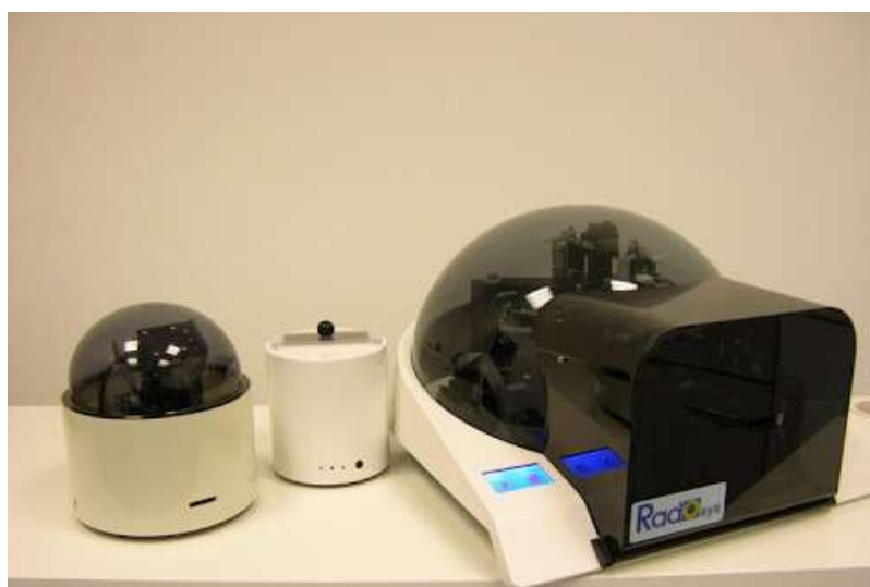
Slika 15. RadoMeter 2000 za detekciju radona pomoću nuklearnih trag detektora [116].
