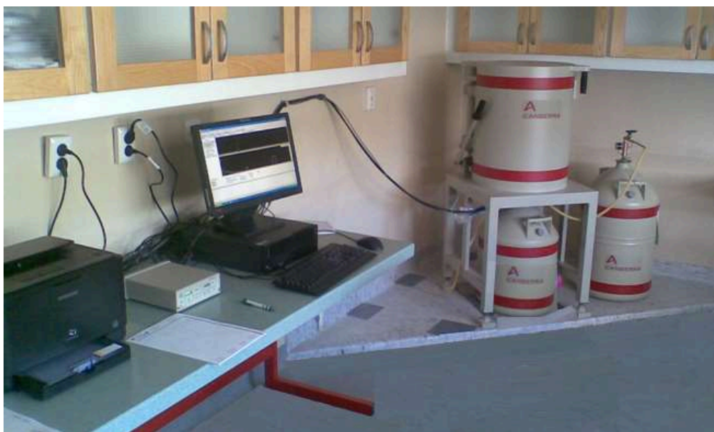
Slika 19. Gama spektrometrijski sistem u LDDZZ (Laboratorija za dozimetriju, detekciju i zaštitu od zračenja) Univerziteta u Tuzli.
