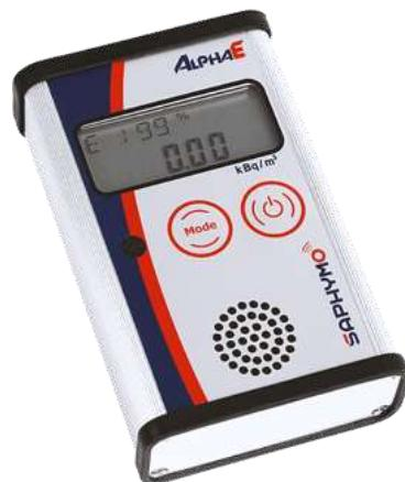
**Slika 14.** AlphaE uređaj za mjerjenje koncentracije aktivnosti radona u vazduhu [114].
