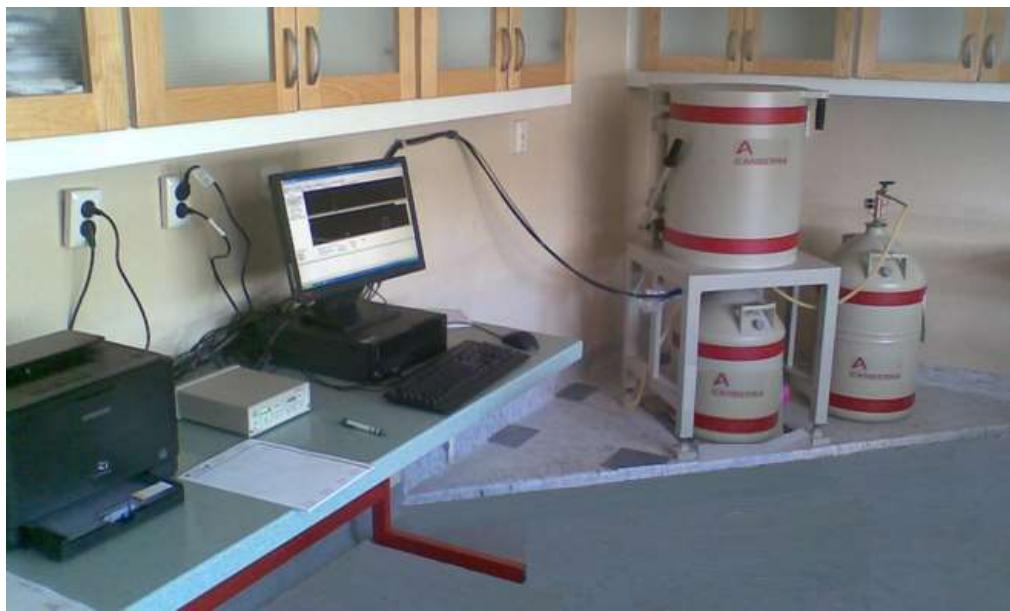
**Slika 19.** Gama spetrometrijski sistem u LDDZZ (Laboratorijska za dozimetriju, detekciju i zaštitu od zračenja) Univerziteta u Tuzli.
