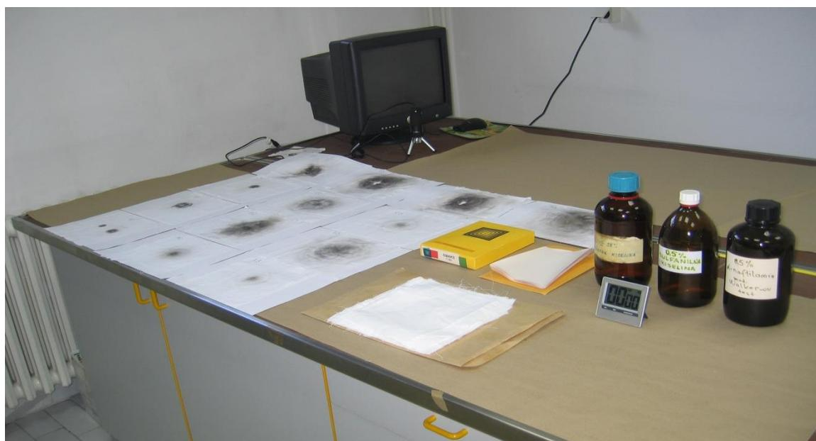
Slika br.13 Oprema potrebna za izvođenje modificirane Walker-ove metode
