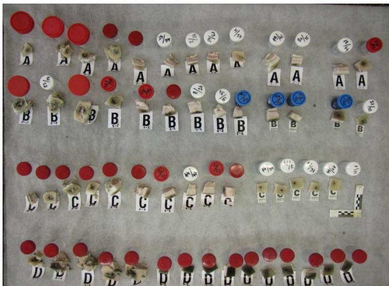
Slika br.11 Uzorci za AAS (atomsku apsorpcionu spektrofotometriju) metodologiju
