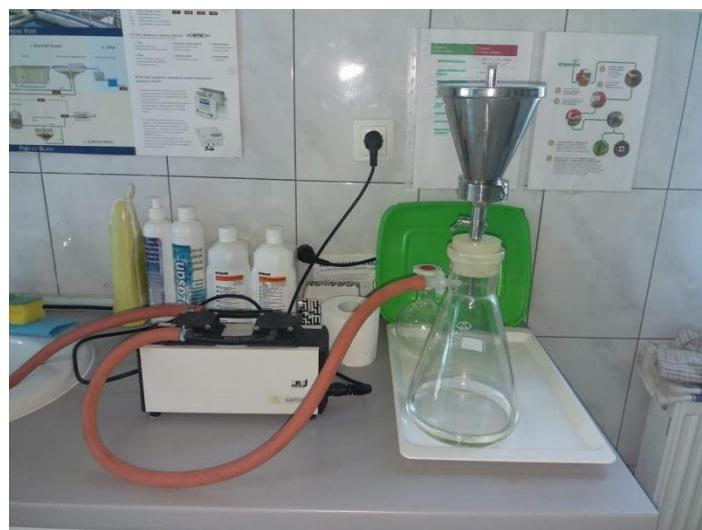
Slika 25. Mikrobiološka analiza vode na ulazu i izlazu biljnog uređaja primjenom membranske filtracije
