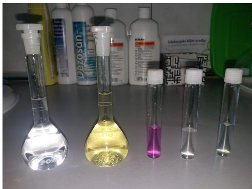
Slika 10. Određivanje spojeva s dušikom u komunalnoj otpadnoj vodi
