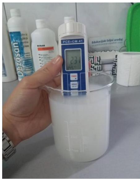
Slika 20. Mjerenje elektroprovodljivosti u otpadnoj vodi mljekarske industrije
