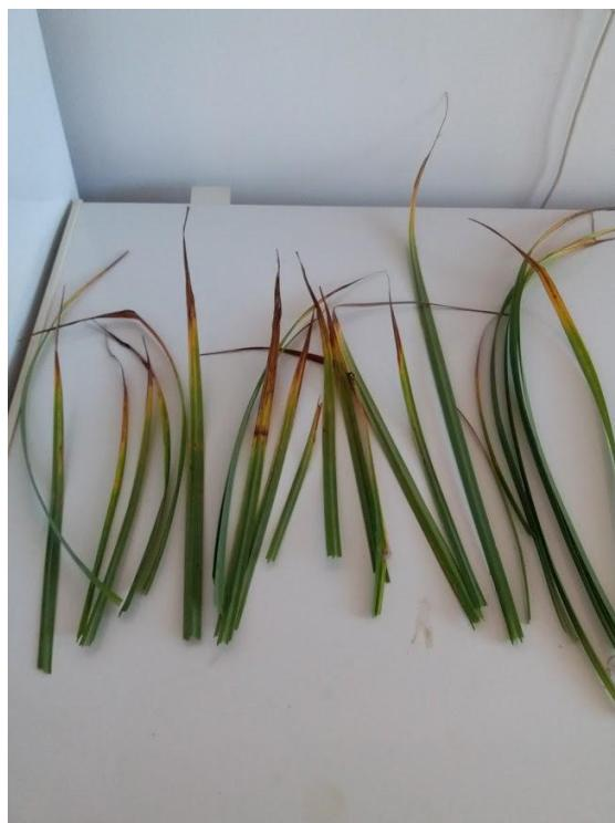
Slika 13. Priprema biljnog materijala za određivanje teških metala na AAS nakon primjene biljnog uređaja za prečišćavanje komunalne otpadne vode
