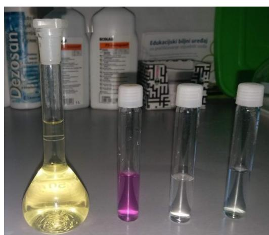
Slika 32. Priprema uzorka za određivanje spojeva s dušikom i fosforom u sintetskoj otpadnoj vodi
