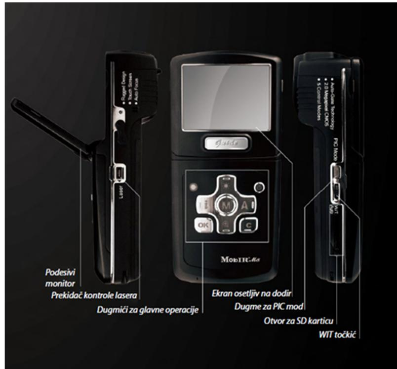
Slika 36. Termovizijska kamera MobIR M8.
