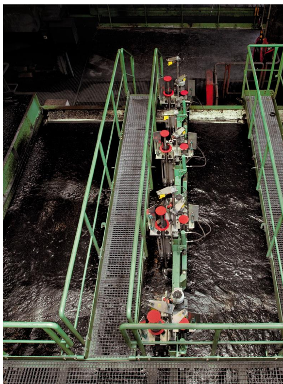
Slika 27. Batac taložnica u radu
