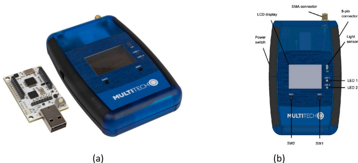
Slika 6.4 Izgled MTDOT-BOX uređaja (a) i oznake tastera, indikatora i konektora (b) [45]
