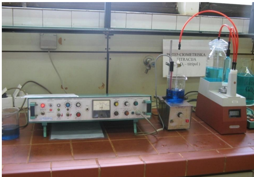
Slika 24. TITRIPOL - instrument za određivanje \text{Al}_2\text{O}_3 potenciometrijskom titracijom (Ostojić, 2013)
