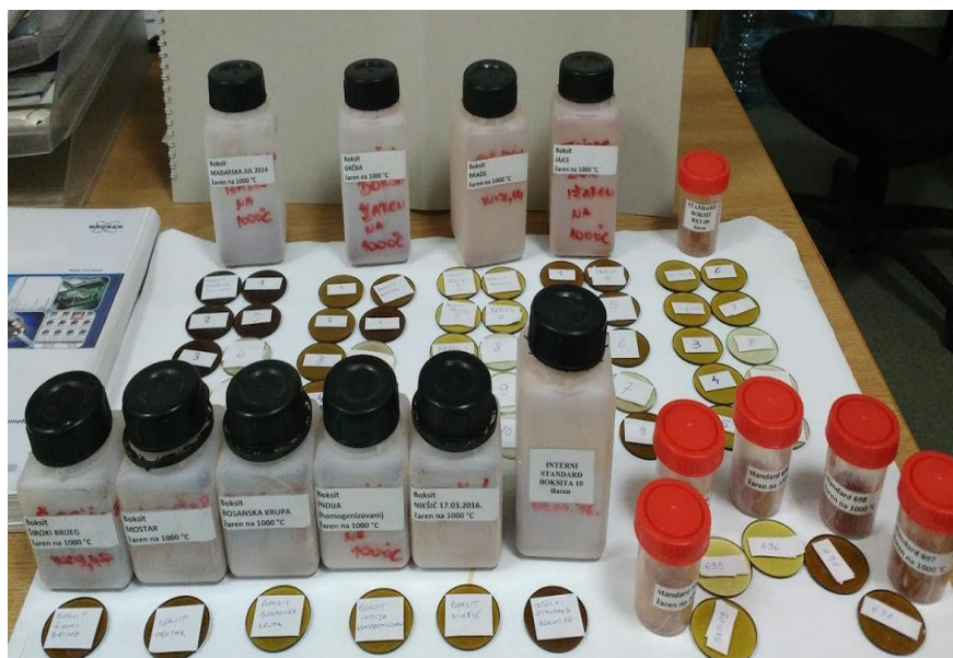
Slika 28. Uzorci i pripremljene topljene perle (foto: autor)
