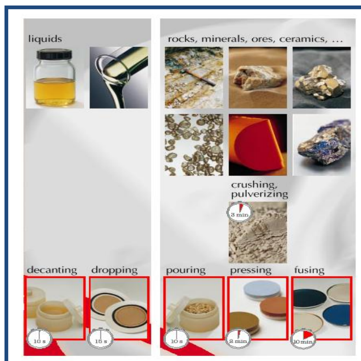
Slika 16. Načini pripreme uzoraka za XRF analizu (BRUKER)
