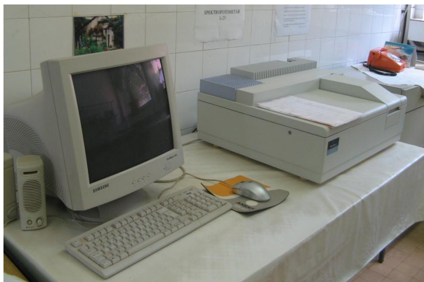
Slika 25. UV-VIS spektrofotometar Perkin Elmer Lambda 25 (Ostojić, 2013)
