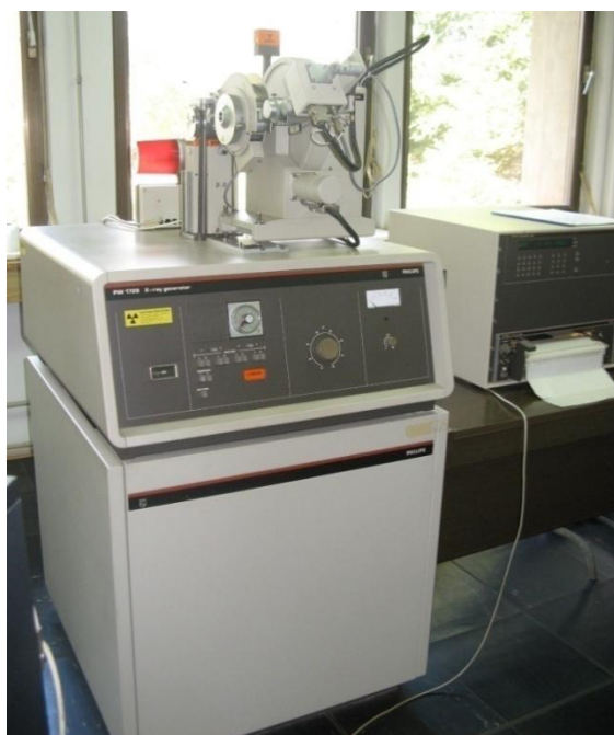
Slika 23. Aparat za rendgensku difrakcionu analizu, difraktometar PHILIPS PW 1710 (Ostojić, 2013).
